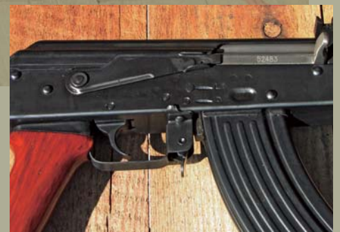
Komora zamkowa cywilnego chińskiego kałasznikowa – widoczne trzy położenia bezpiecznika, jak w wojskowym modelu
